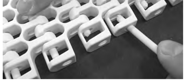
Şekil 287: Çubuğu menteşelerin içinden geçirin
