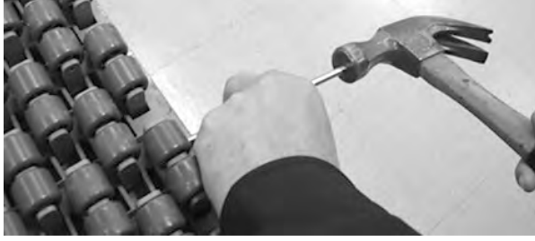
Şekil 194: Çubuğu banttın itin
