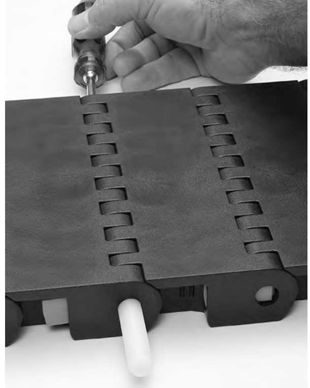
Şekil 263: Çubuğu banttan itin
