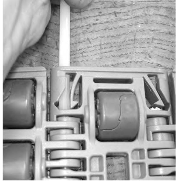
Şekil 221: Çubuğu banttan itin
