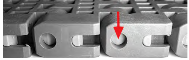
Şekil 155: Slidelox'un açık olduğundan emin olun
