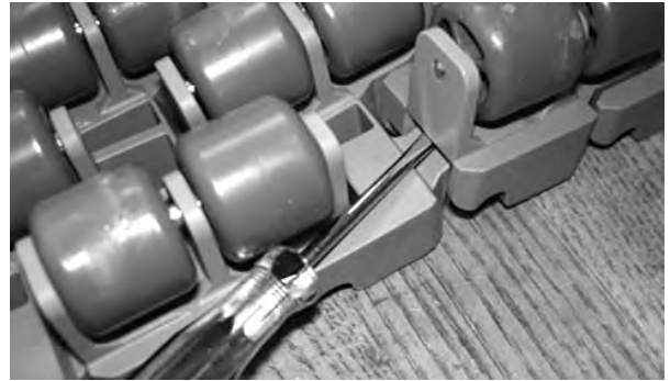
Şekil 192: Tornavidayı makaranın altına yerleştirin
