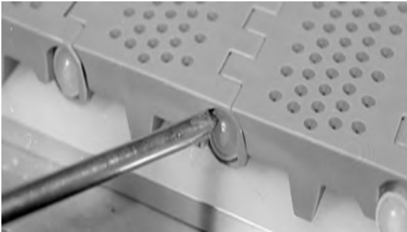
Şekil 64: Çubuk başının snap-lock'ı geçtiğinden emin olun
