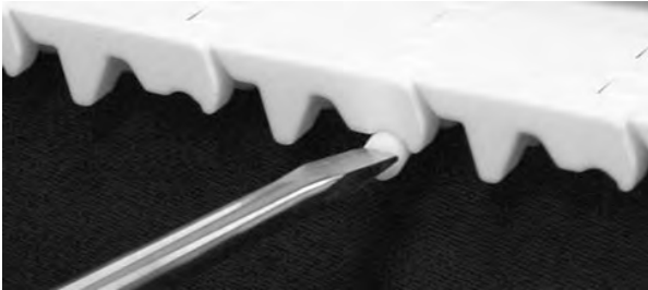
Şekil 174: Çubuğu, tutma unsurunu geçecek şekilde itme
