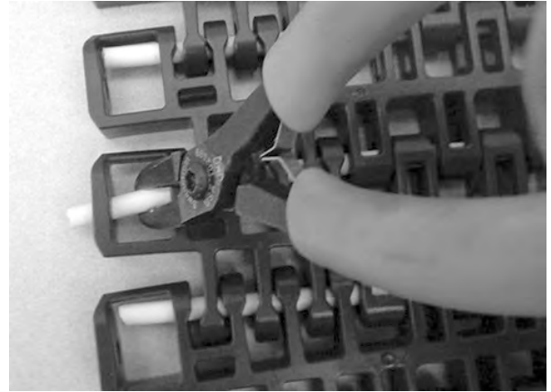
Şekil 357: Çubuğu, tutma unsurunu geçecek şekilde itme
