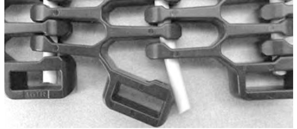
Şekil 325: Çubuğu bant kenarından itin
