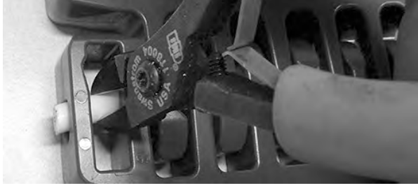
Şekil 333: Çubuğu yana itin ve kapalı deliği geçin
