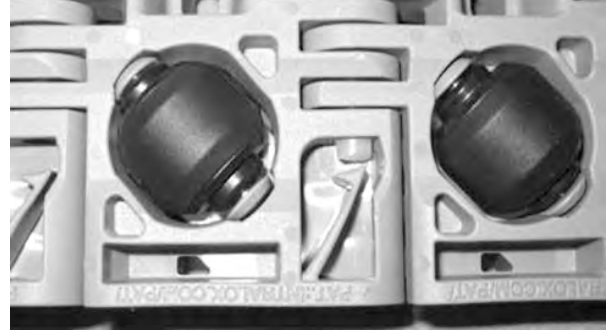
Şekil 226: Çubuğun tutma unsurunu geçtiğinden emin olun
