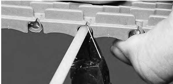
Şekil 24: Çubuğu bant kenarı ile düz şekilde kesin
