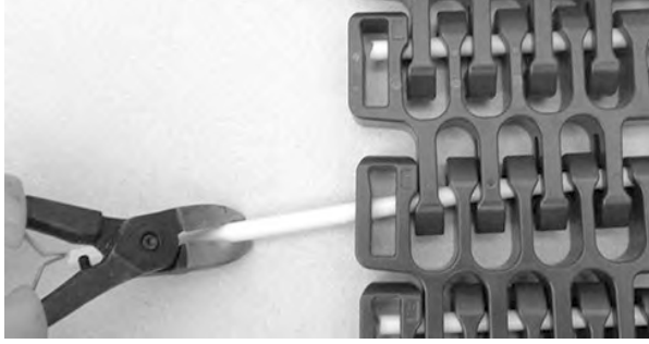
Şekil 317: Çubuğu banttan çekin
