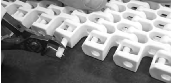
Şekil 291: Çubuğu banttan çekin
