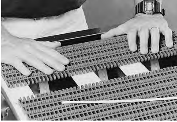
Şekil 13: Bant uçlarını birbirine itin
