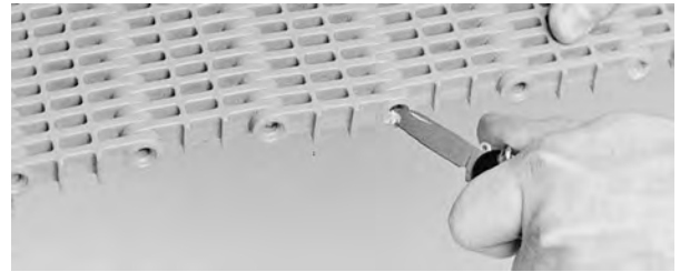
Şekil 31: Açık çubuk deliği
