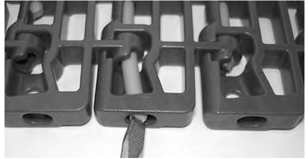
Şekil 123: Çubuğu, tutma unsurunu geçecek şekilde itme
