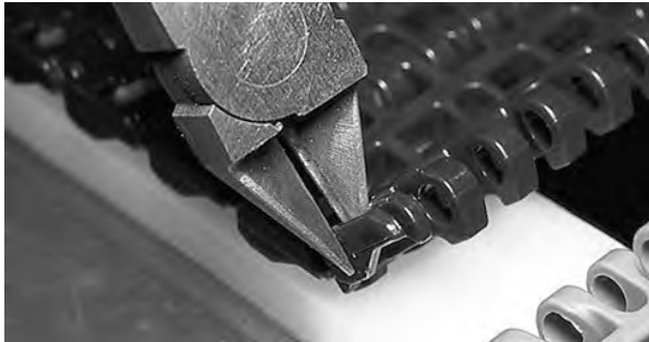
Şekil 150: Kenar elemanını kesin
