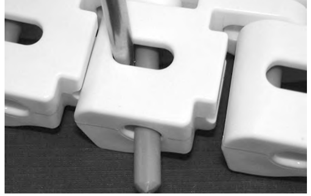
Şekil 285: Çubuğu, tutma unsurunun içerisine itin
