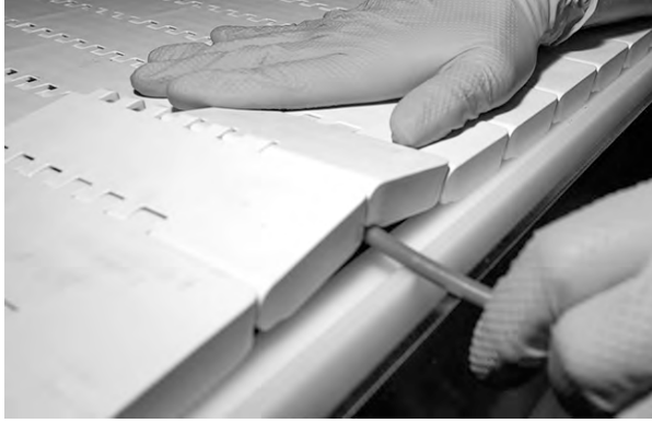
Şekil 88: Çubuğu hafifçe bükün ve menteşelerden geçirin
