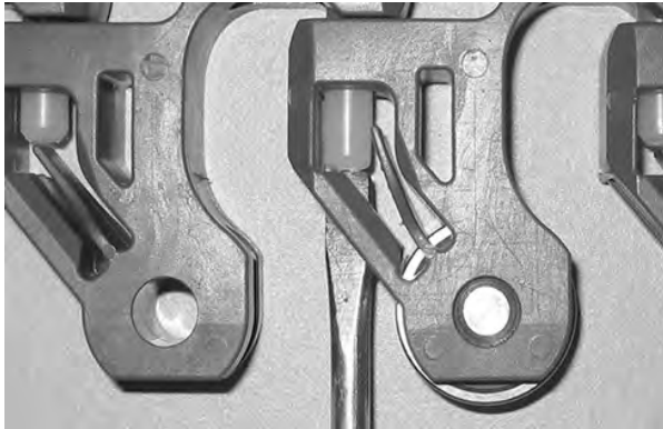
Şekil 278: Çubuğu, tutma unsurunu geçecek şekilde itme
