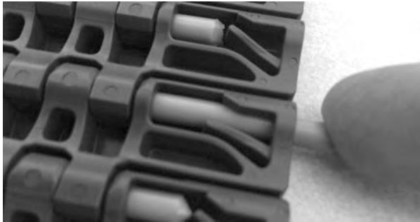
Şekil 127: Çubuğu menteşenin içinden geçirin
