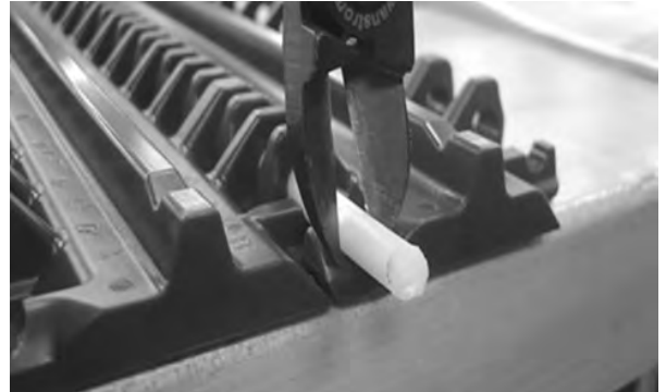
Şekil 101: Çubuğu banttan çekin
