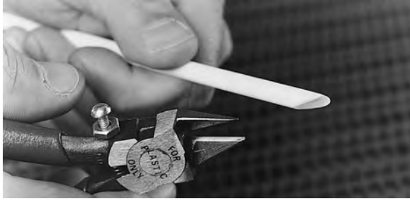
Şekil 14: Çubuğu açılı olarak bağlayın
