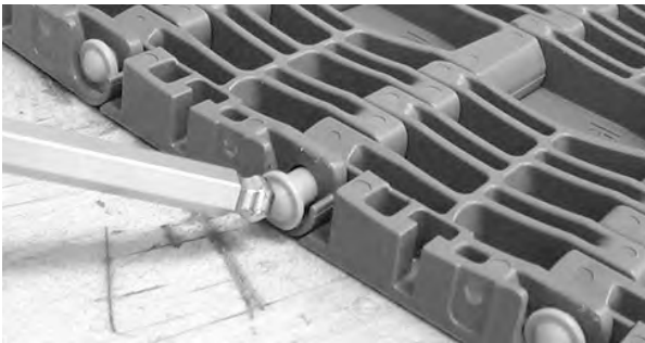
Şekil 267: Çubukcuğu tutma unsurunu geçecek şekilde itin
