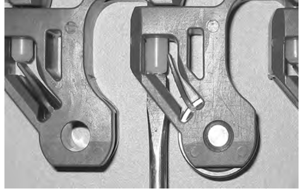
Şekil 300: Çubuğu, tutma unsurunu geçecek şekilde itme
