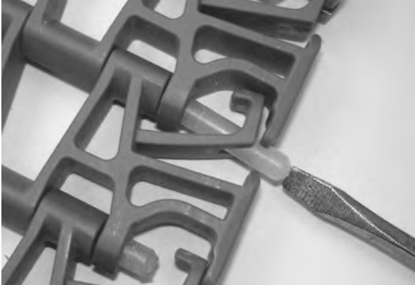
Şekil 247: Çubuğu, tutma unsurunu geçecek şekilde itme
