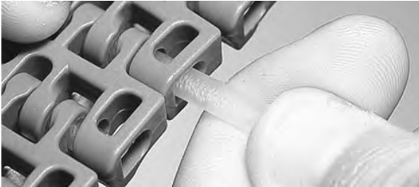
Şekil 135: Çubuğu menteşelerin içinden geçirin
