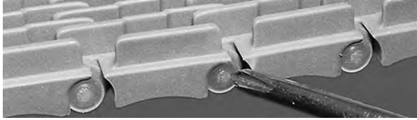
Şekil 23: Çubuk başının snap-lock'ı geçtiğinden emin olun
