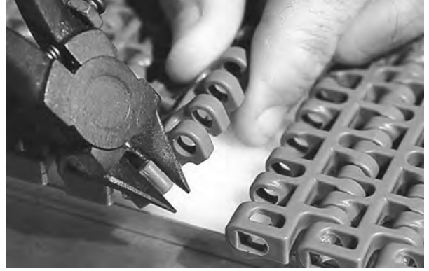
Şekil 142: Kenarı banttın kesin
