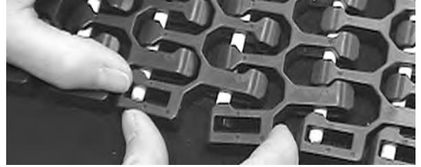
Şekil 307: Çubuğu bant kenarından itin, düz kenarı çubuk üzerine oturtun
