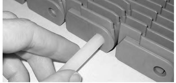
Şekil 218: Çubuğu banttan çekin
