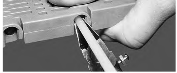
Şekil 39: Çubuğu bant kenarı ile düz şekilde kesin
