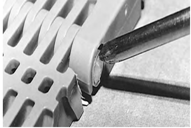
Şekil 48: Çubuğu, tutma unsurunu geçecek şekilde itin
