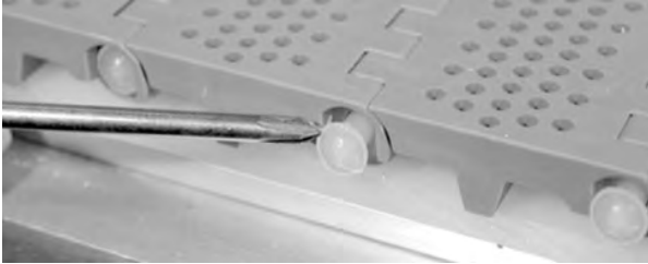
Şekil 63: Çubuğu bandın içine itin
