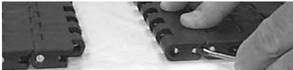
Şekil 160: Slidelox'u kapatmak için tornavida kullanın
