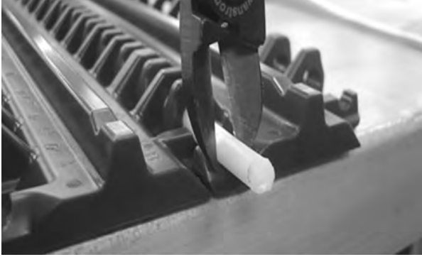
Şekil 72: Çubuğu banttan çekin
