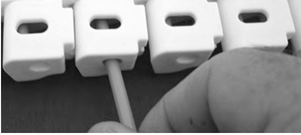
Şekil 282: Çubuğu menteşelerin içinden geçirin
