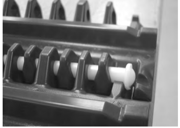
Şekil 99: Çubuğun tutma unsurunu geçtiğinden emin olun
