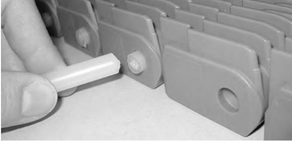
Şekil 216: Çubuğu Shuttleplug'ı geçecek şekilde itin
