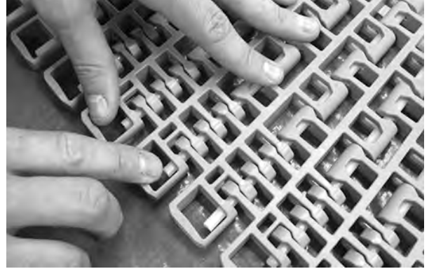
Şekil 339: Çubuğun tutma unsurunu geçtiğinden emin olun
