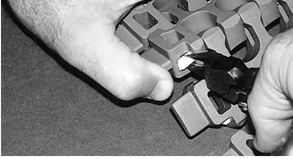
Şekil 273: Çubuğu tutma unsurunun üzerinde serbest bırakın
