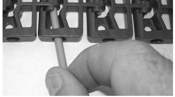
Şekil 122: Çubuğu menteşelerin içinden geçirin
