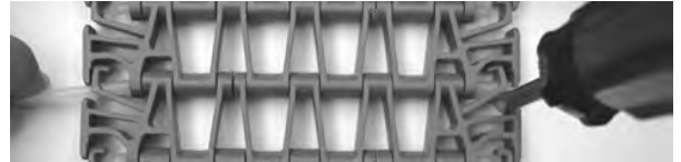
Şekil 250: Çubuğu banttan itin
