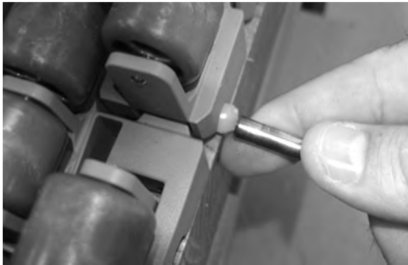
Şekil 190: Çubuğu, tutma unsurunu geçecek şekilde itme
