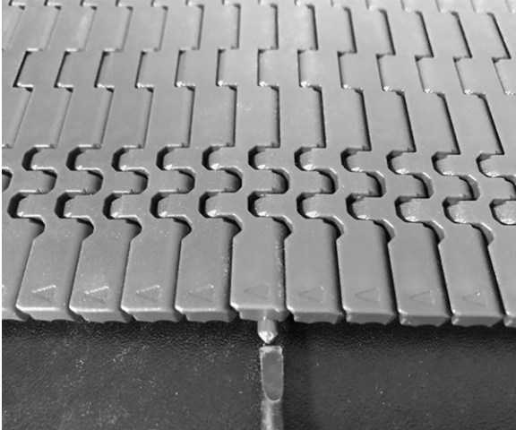
Şekil 59: Çubuğu, tutma unsurunu geçecek şekilde itme
