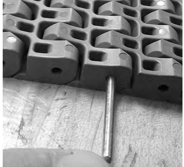
Şekil 269: Çubuğu ve çubukcuğu banttan itin
