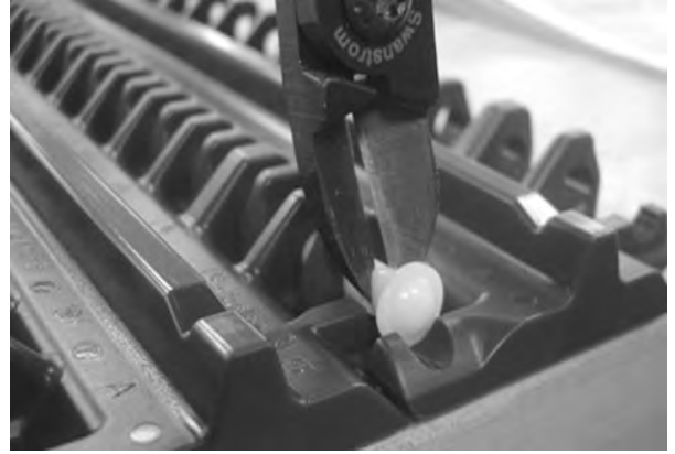
Şekil 100: Çubuk başını kesin
