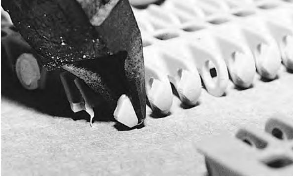
Şekil 27: Ara parça ucunu kesin
