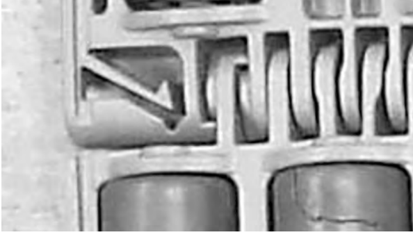
Şekil 223: Çubuğun tutma unsurunu geçtiğinden emin olun
