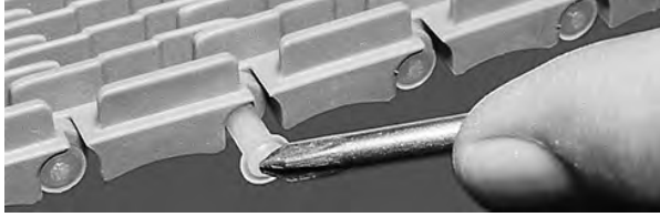
Şekil 22: Çubuğu bandın içine itin
