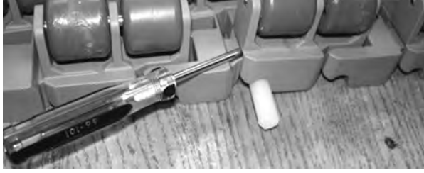
Şekil 195: Çubuğu banttın çekin
