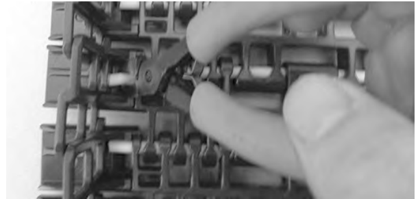
Şekil 367: Çubuğu, tutma unsurunu geçecek şekilde itme
