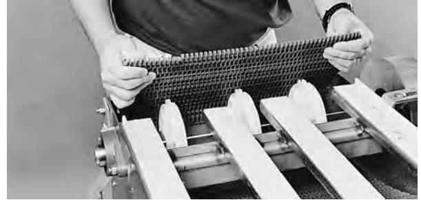
Şekil 11: Bantı geridönüşten besleyin
