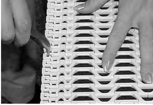
Şekil 171: Çubuğu banttan çekin
