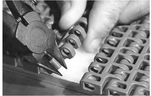
Şekil 152: Kenarı banttardan kesin
