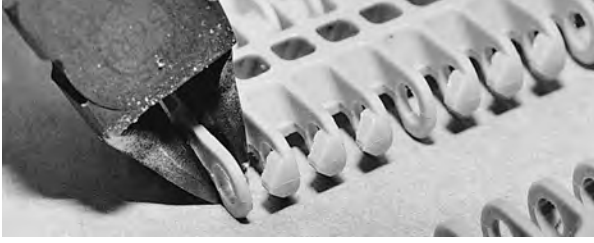
Şekil 26: En dıştaki bağlantıyı kesin
