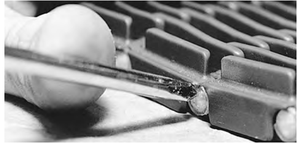
Şekil 112: Çubuğun snap-lock'ı geçtiğinden emin olun
