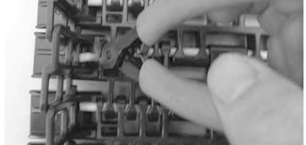
Şekil 353: Çubuğu banttın çekin
