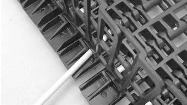
Şekil 350: Çubuğu menteşelerin içinden geçirin
