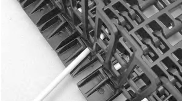
Şekil 364: Çubuğu menteşelerin içinden geçirin
