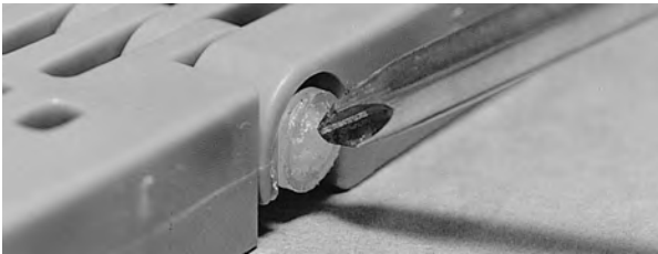
Şekil 38: Çubuk başının snap-lock'ı geçtiğinden emin olun
