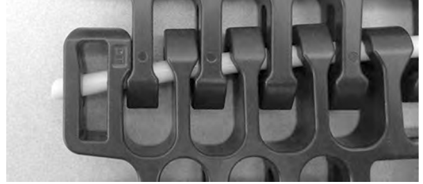
Şekil 314: Çubuğu, tutma unsurunu geçecek şekilde itme
