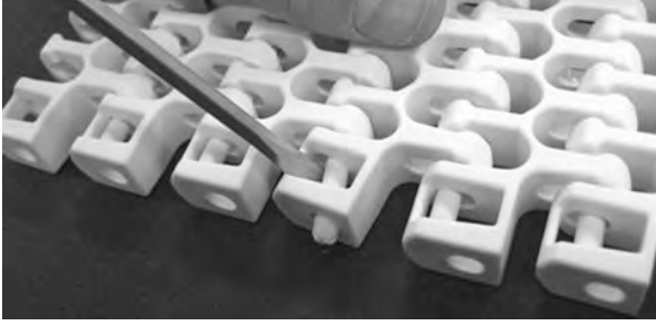
Şekil 290: Çubuğu, tutma unsurunun içerisine itin
