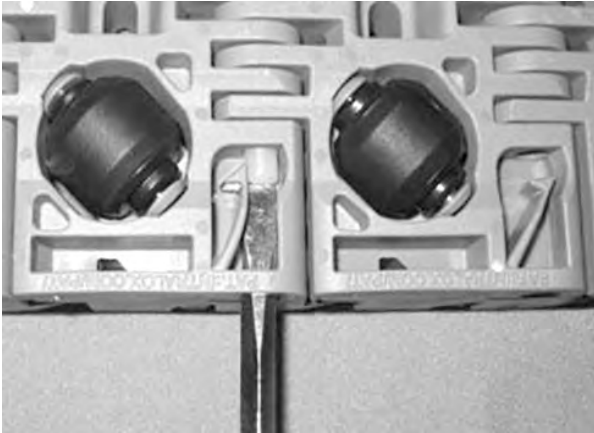
Şekil 231: Çubuğu, tutma unsurunu geçecek şekilde itme
