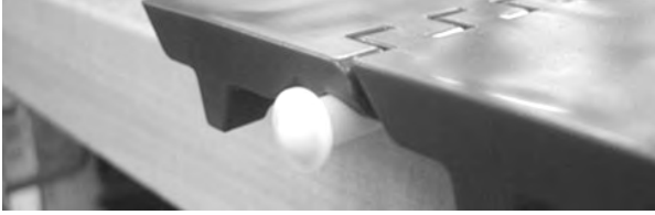
Şekil 96: Çubuğu menteşelerin içinden geçirin
