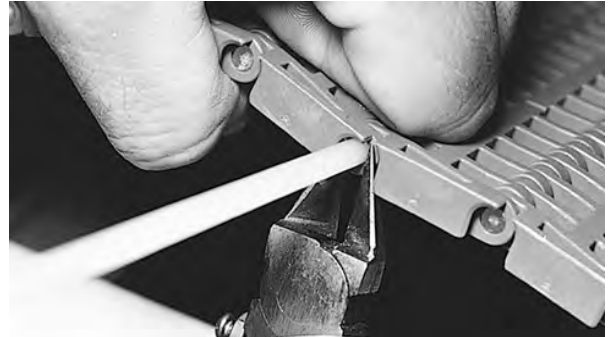
Şekil 113: Çubuğu bant kenarı ile düz şekilde kesin
