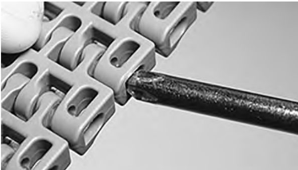
Şekil 136: Çubuğu, tutma unsurunu geçecek şekilde itme
