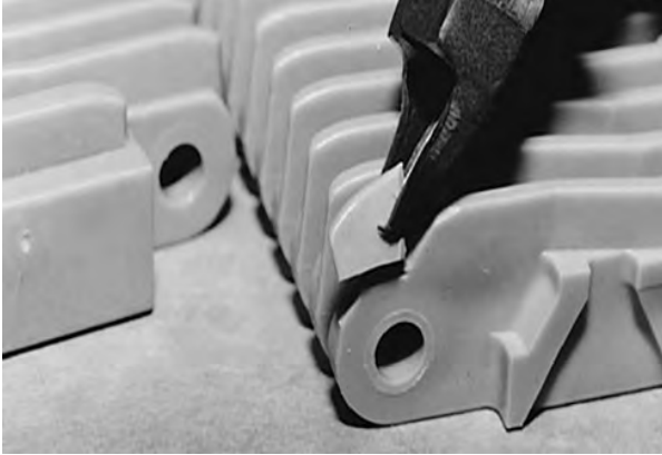
Şekil 47: En dıştaki nervürü kesin
