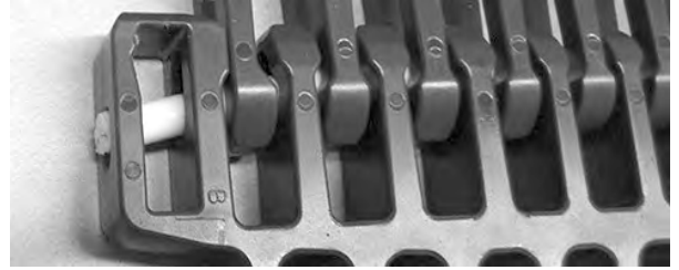
Şekil 331: Çubuğu menteşelerin içinden geçirin
