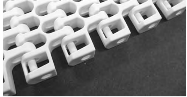
Şekil 289: Çubuğun tutma unsurunu geçtiğinden emin olun
