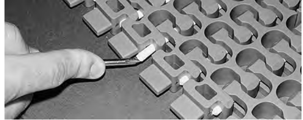
Şekil 271: Çubuğun tutma unsurunu geçtiğinden emin olun
