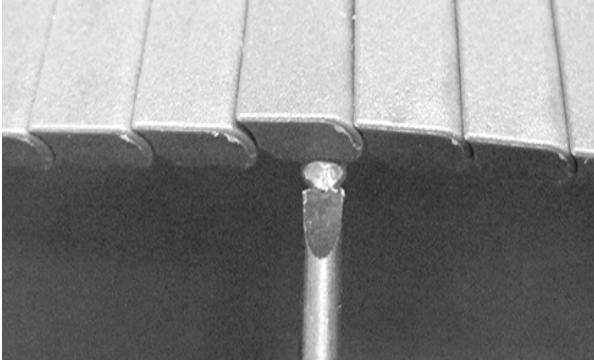
Şekil 54: Çubuğu, tutma unsurunu geçecek şekilde itin
