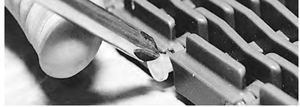
Şekil 111: Çubuğu bandın içine itin
