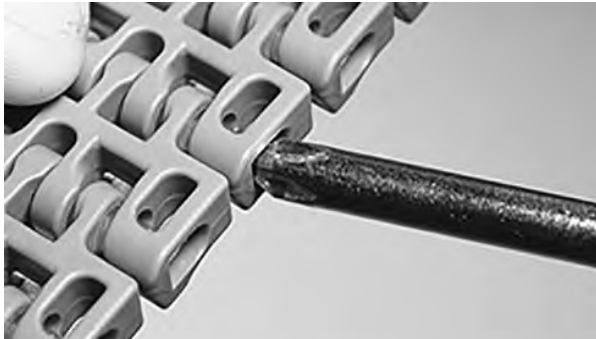
Şekil 145: Çubuğu, tutma unsurunu geçecek şekilde itme
