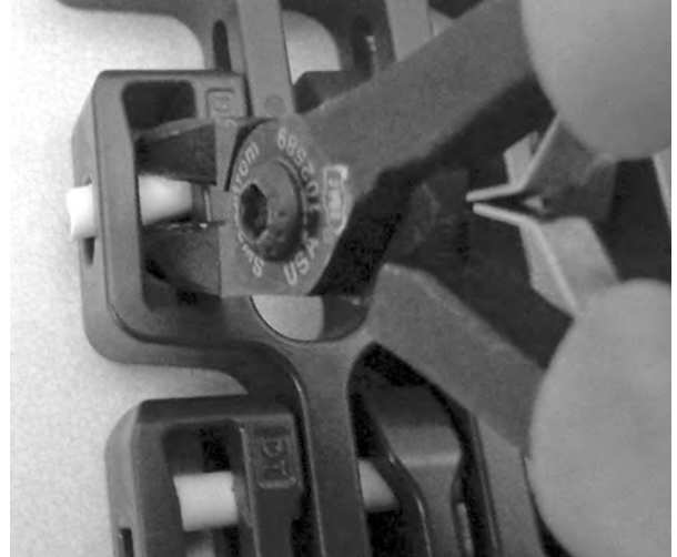
Şekil 316: Çubuğu yana itin ve deliği geçin
