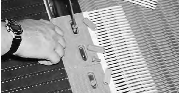
Şekil 18: Intralox plastik cıvataları kullanarak taraklı aktarma tavalarını takın
