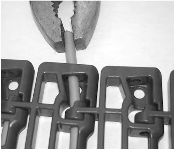
Şekil 126: Çubuğu banttandır çekin
