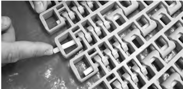
Şekil 338: Çubuğu, tutma unsurunu geçecek şekilde itme
