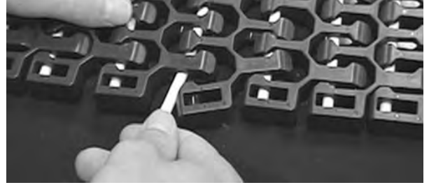
Şekil 306: Çubuğu menteşelerin içinden geçirin
