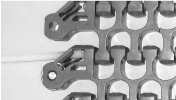
Şekil 299: Çubuğu banttan çekin
